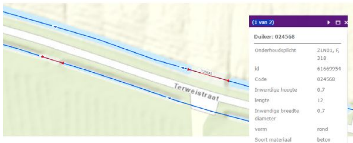
Figuur 2.2b: Het waterstaatswerk duiker. Op de legger wateren staan ruim 30.000 duikers.
